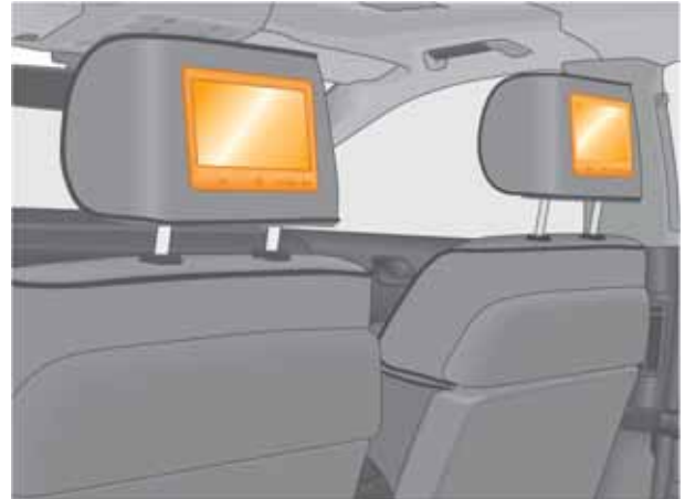
Einbaute Monitore Y22 (links) und Y23 (rechts)
