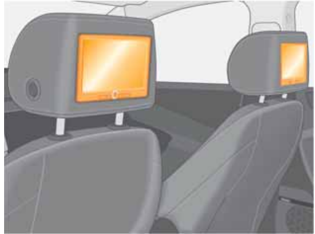
Einbauorte Monitor Y22 (links) und Y23 (rechts)
